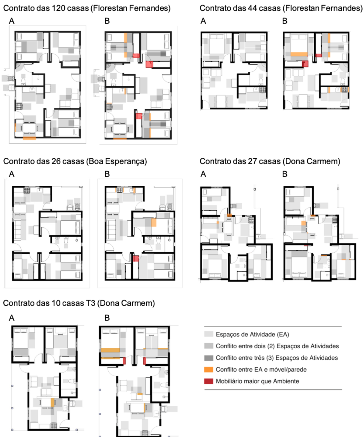
Figura 04. Comparativo do (A) mobiliário do PNH/ MCMV e (B) atualização feita pelo Bueri, Pedro e Scoaris (2012) nas unidades habitacionais estudadas
