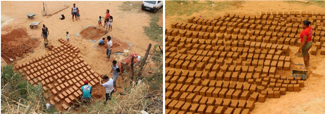
Figura 20: Mutirão para produção de tijolos de adobe na Ocupação Paulo Freire, 2018. fonte: Acervo da Equipe de Comunicação do MLB
