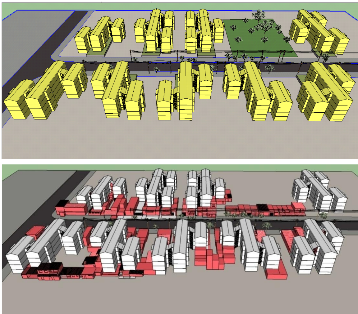
Figura 30 - Conjunto Habitacional Curado III. Imagem 3D – Configuração original e a resultante das intervenções efetuadas pelos moradores. Fonte: MONTEIRO, 2000.
