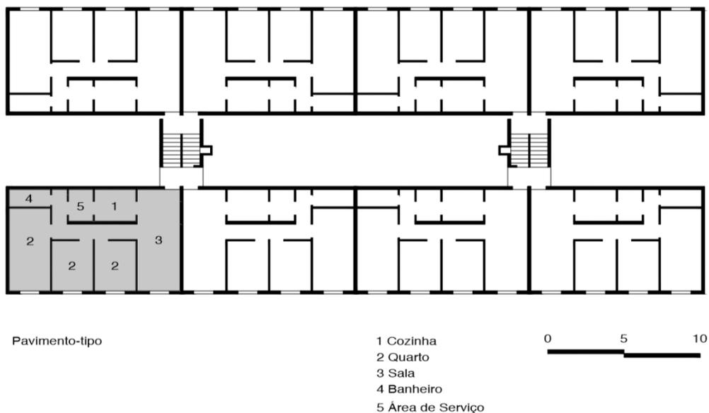
Figura 10 - Conjunto Novo Mundo: pavimento tipo.
