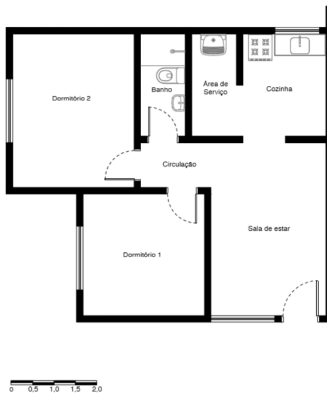
Figura 26. PROSAMIM: tipologia habitacional básica. Desenho: Lucas de Abreu, elaborado com base em imagem cedida pelo Governo do Estado do Amazonas.
