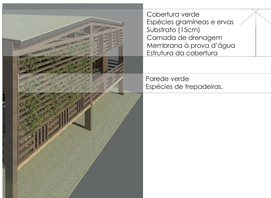
Figura 17 – Anteprojeto do módulo escolar demonstrando a composição e especificações da cobertura e parede verdes na fachada norte, em Anamã/AM.
