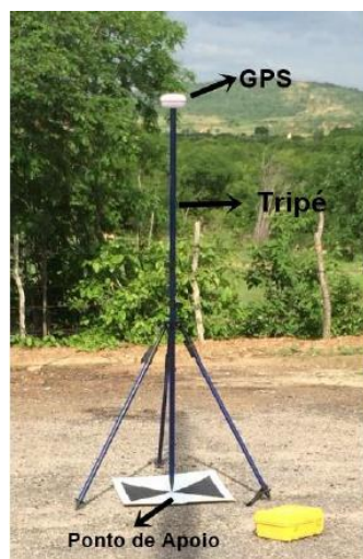
Figura 04-Alvo e GPS na execução das práticas
