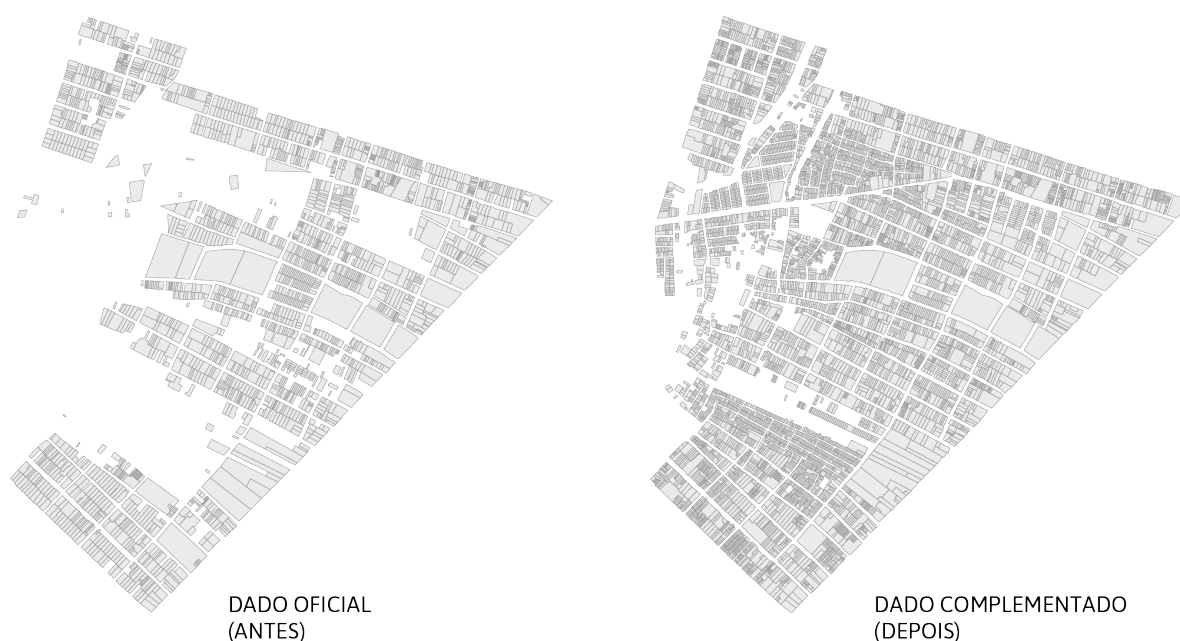
FIGURA 3. COMPARAÇÃO ENTRE O DADO DA GEOMETRIA DOS LOTES ANTES (OFICIAL) E O DADO DEPOIS DO DESENHO DOS LOTES FALTANTES
