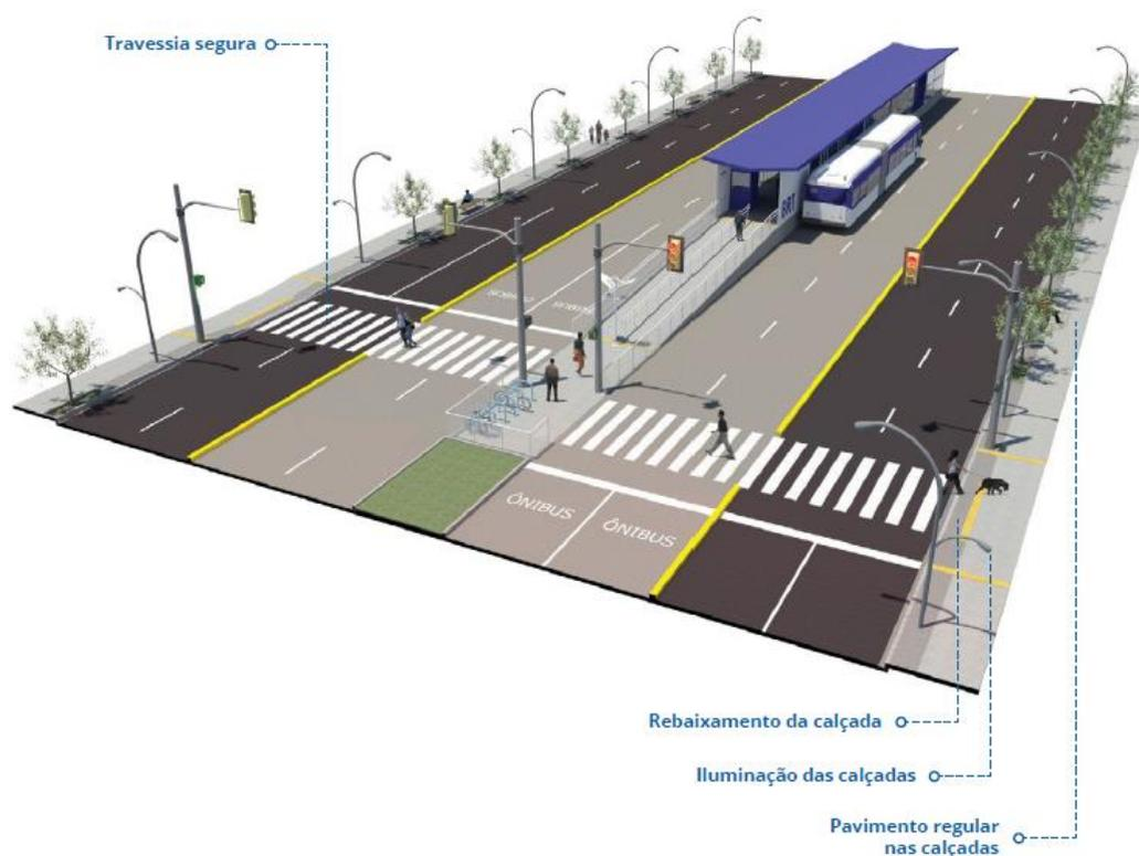
Figura 3, representação ilustrativa de garantia a necessidades do pedestre. Fonte: Caderno Técnico do Sistema de Prioridade ao Ônibus, Brasil (2017)
