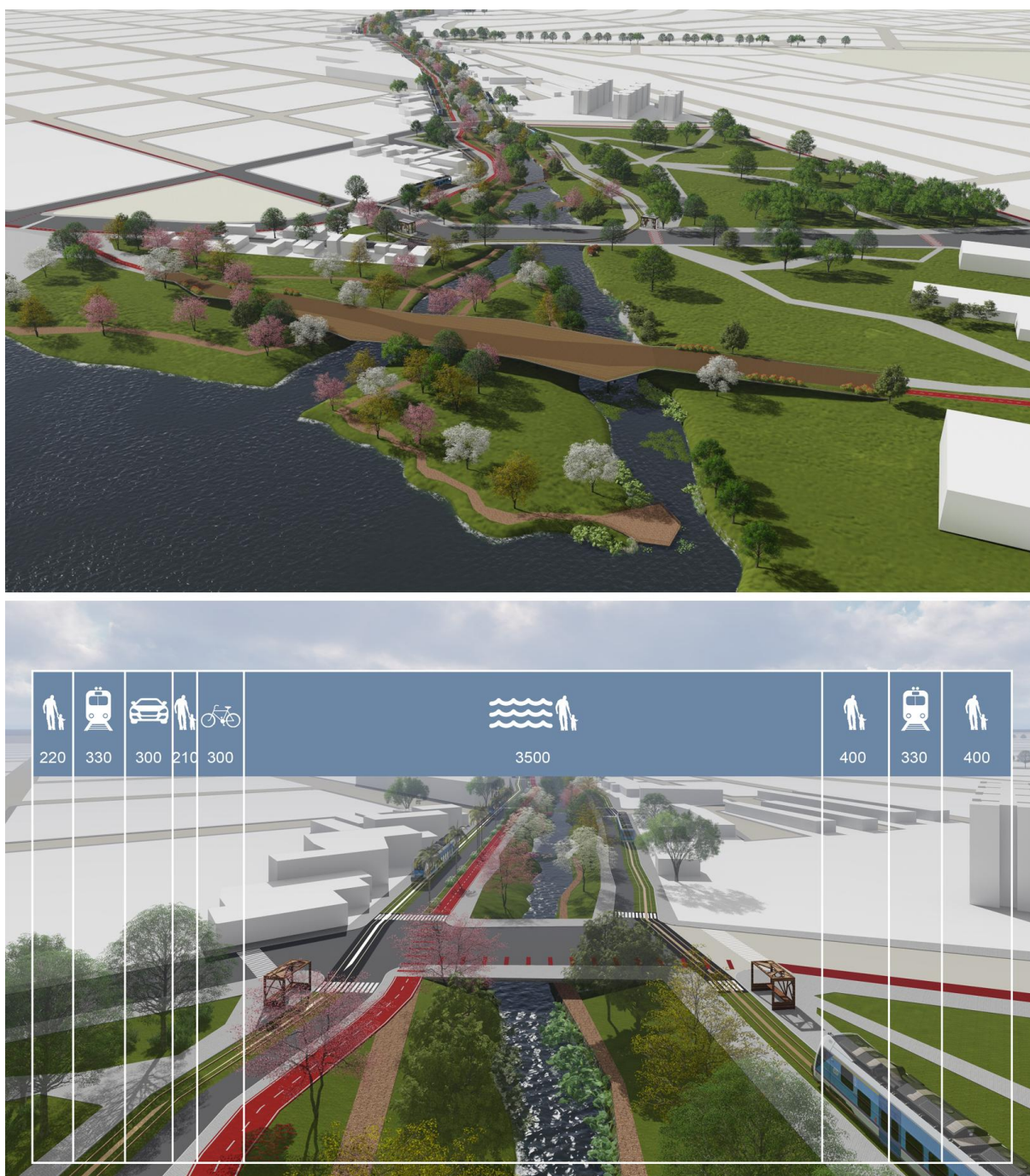
Figura 12: Proposta de renaturalização, voo de pássaro na foz do arroio e corte esquemático. Fonte: Autor do projeto / 2017. Adaptação: dos autores / 2018.
