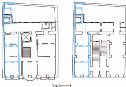
Figura 3 - Sobrado situado a Rua de Nazaré Nº 200 (Pav. Superior e Térreo) sob planta da tipologia genérica porta-e-janela
