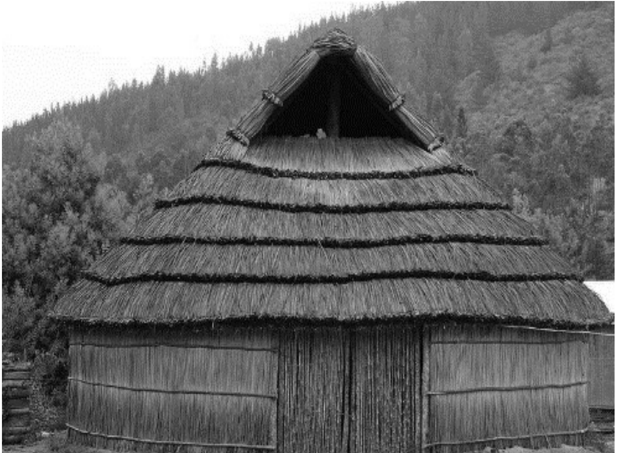
Figura 1: Fotografía de una ruka, donde se puede apreciar su relación material con el entorno natural. La materialidad es principalmente madera, barro y paja.
