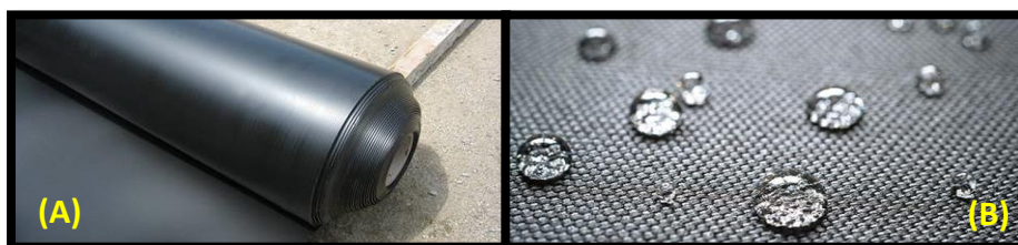
Figura 8: (A) Geomembrana; (B) Propriedade Impermeabilizante.
