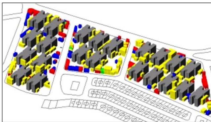
Figura 28 - Conjunto Habitacional Curado III. Imagem 3D – Configuração original e a resultante das intervenções efetuadas pelos moradores. Fonte: MONTEIRO, 2000.
