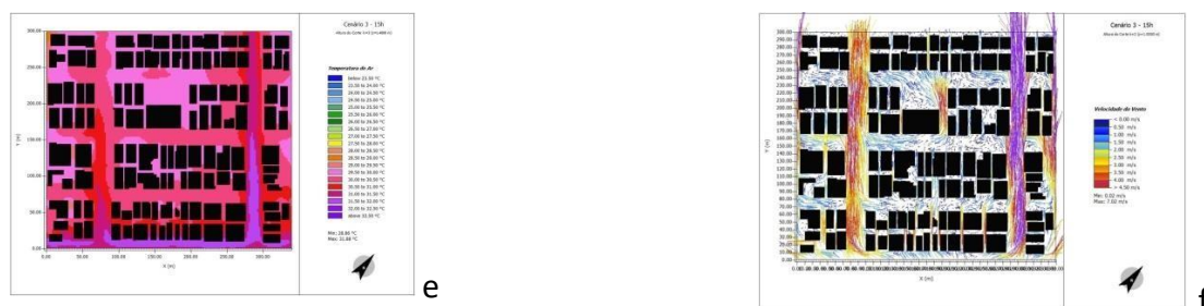
Figura 6. Resultado da simulação da temperatura potencial máxima (e) e velocidade e direção dos ventos (f), da Tipologia Espacial 3 (Ocupação de alto CA e pouco Recuo), para uma condição de verão, às 15h
