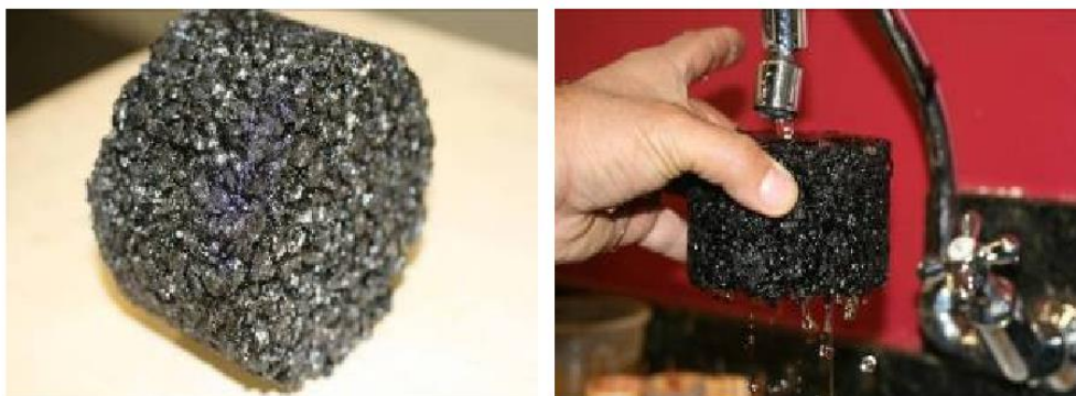
Figura 20: Corpo de prova para avaliação de permeabilidade
