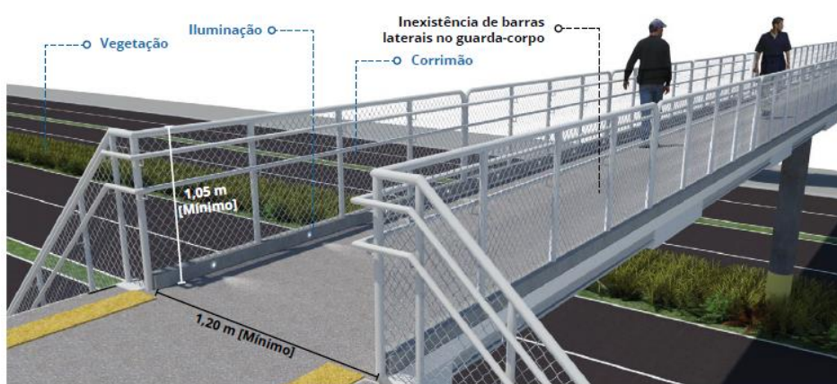
Figura 8, ilustração de especificações de passarelas e guarda-corpo. Fonte: Caderno Técnico do Sistema de Prioridade ao Ônibus, Brasil (2017)
