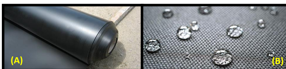
Figura 8: (A) Geomembrana; (B) Propriedade Impermeabilizante.
